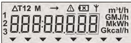
Рисунок 4 – Информационное поле прибора, все символы включены
