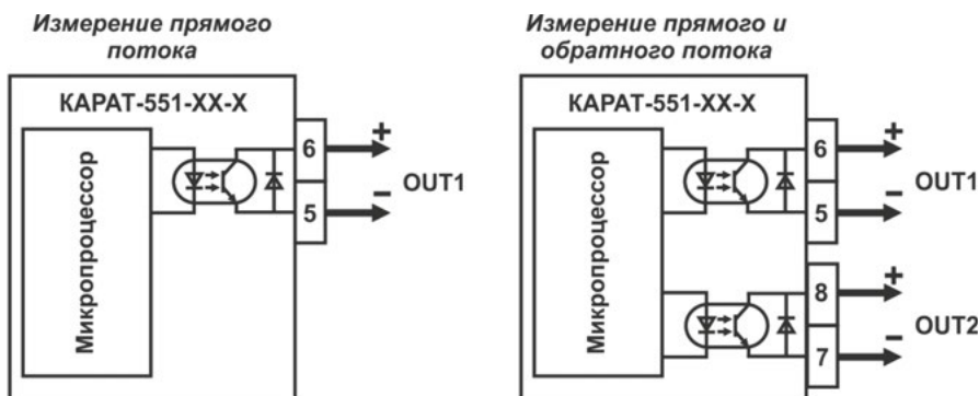
Рисунок 1.2 – Схема применяемых выходных цепей
