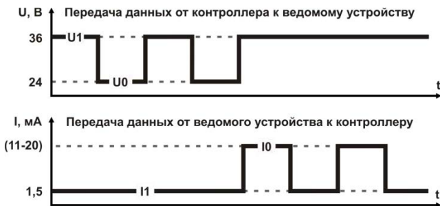
Рисунок 1 – Представление битов данных в интерфейсе M-Bus
