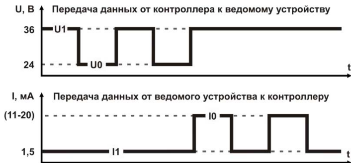
Рисунок 1 – Представление битов данных в интерфейсе M-Bus
