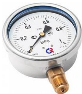
Промышленный виброустойчивый манометр выполнен в корпусе из нержавеющей стали. Применяется для измерения давления неагрессивных жидких и газообразных, не вязких и не кристаллизующихся измеряемых сред с температурой до 150 °С. Этот тип манометра может использоваться в условиях повышенной вибрации и при измерении переменного давления. Повышенная устойчивость к воздействию окружающей среды — степень защиты приборы IP65.
