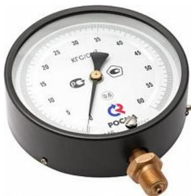
Манометры точных измерений применяются для измерения давления неагрессивных к медным сплавам жидких и газообразных, не вязких и не кристаллизующихся сред с температурой до 100 °С.
