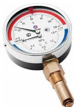
Термоманометры предназначены для одновременного измерения избыточного давления и температуры неагрессивных к медным сплавам сред.
